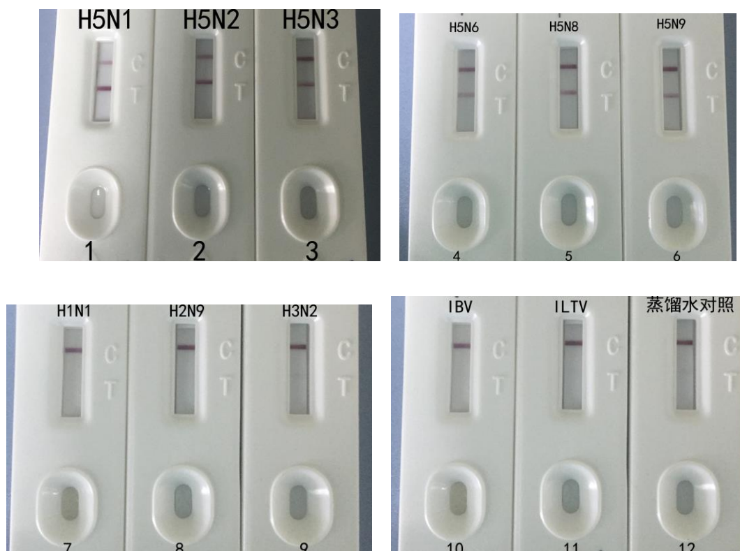
图1 H5亚型禽流感病毒胶体金免疫层析检测试纸卡特异性检测结果
