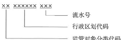
图 15 无害化处理场标识代码组成图
